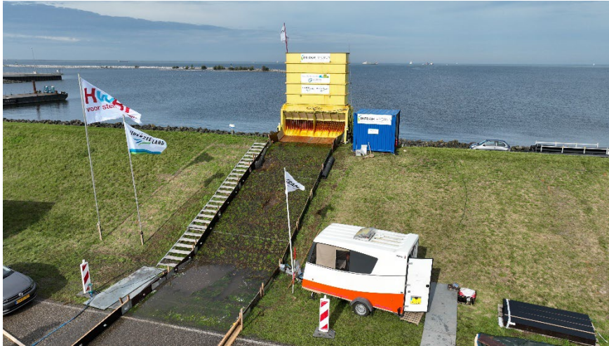
Figuur 5: De WOS op de kruin bij teststrook 0.
