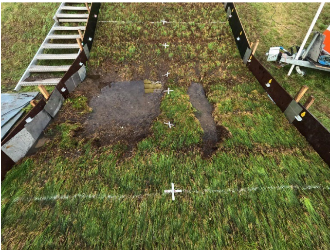
Figuur 22: Erosie ter plaatse van de geometrische overgang na vier stormuren proef GO50_3.2, teststrook 0.
