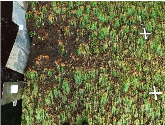
Figuur 14: Erosie in vak 4A einde proef GO10_1, teststrook 0.
