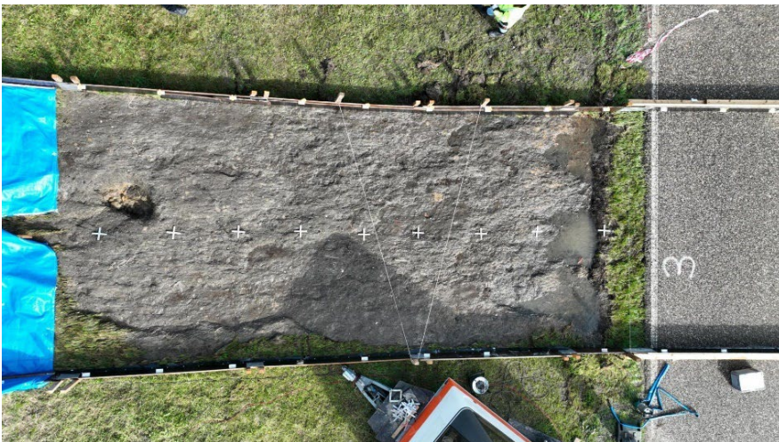
Figuur 52: Erosiegat vak 7C einde proef GO50_3.2, teststrook 3.
