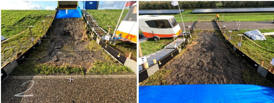
Figuur 40: Erosiekuil op het boventalud na twee uur proef GO50_3.2, teststrook 2.
