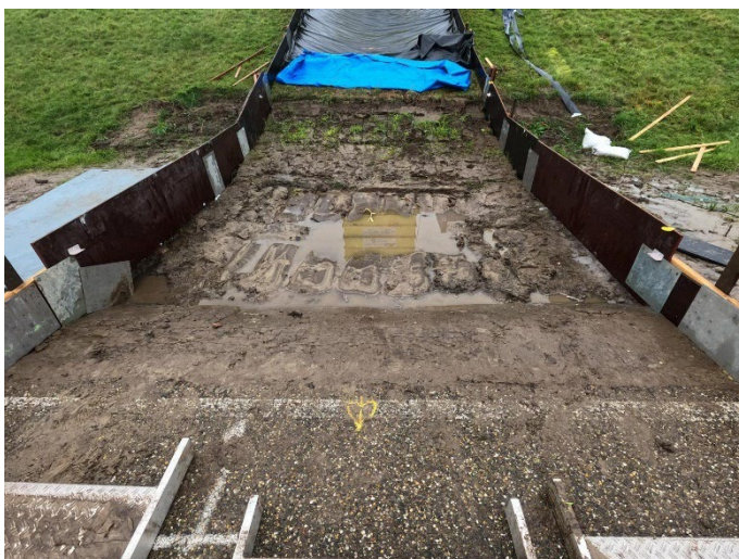
Figuur 68: Uitspoeling grond onder afdekking einde proef GO100_3.2, teststrook 1 (sessie 1).
