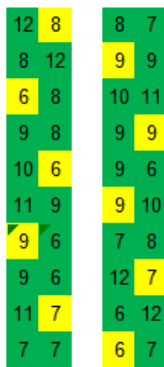
Figuur 93: Gemiddelde dikte uitgetrokken zode proeven boventalud (links) en ondertalud (rechts) teststrook 0 zonder afdekking.
