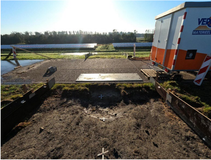
Figuur 57: Schadebeeld ter hoogte van overgang gras-asfalt einde GO100_3.2, teststrook 3.
