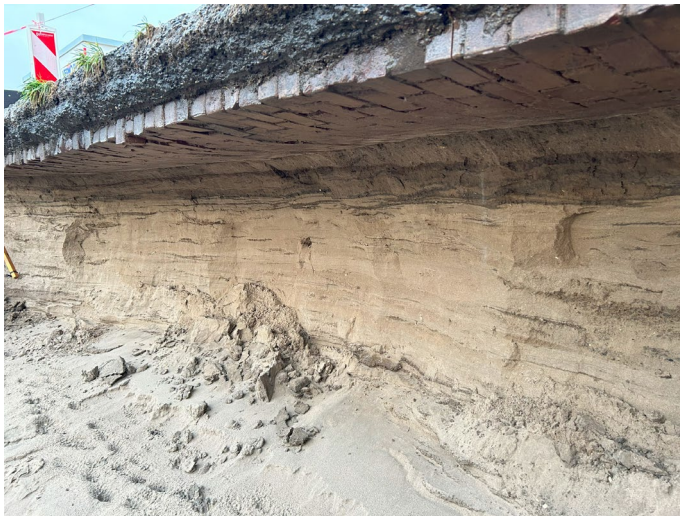
Figuur 79: De onder het asfalt aanwezige klinkerbestrating blijft ook hangen, teststrook 1 (sessie 3).
