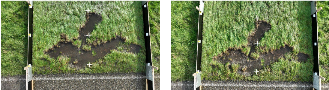
Figuur 59: Aangebrachte schade na 2,5 uur (links) en einde (rechts) proef GO10_1, teststrook 4.
