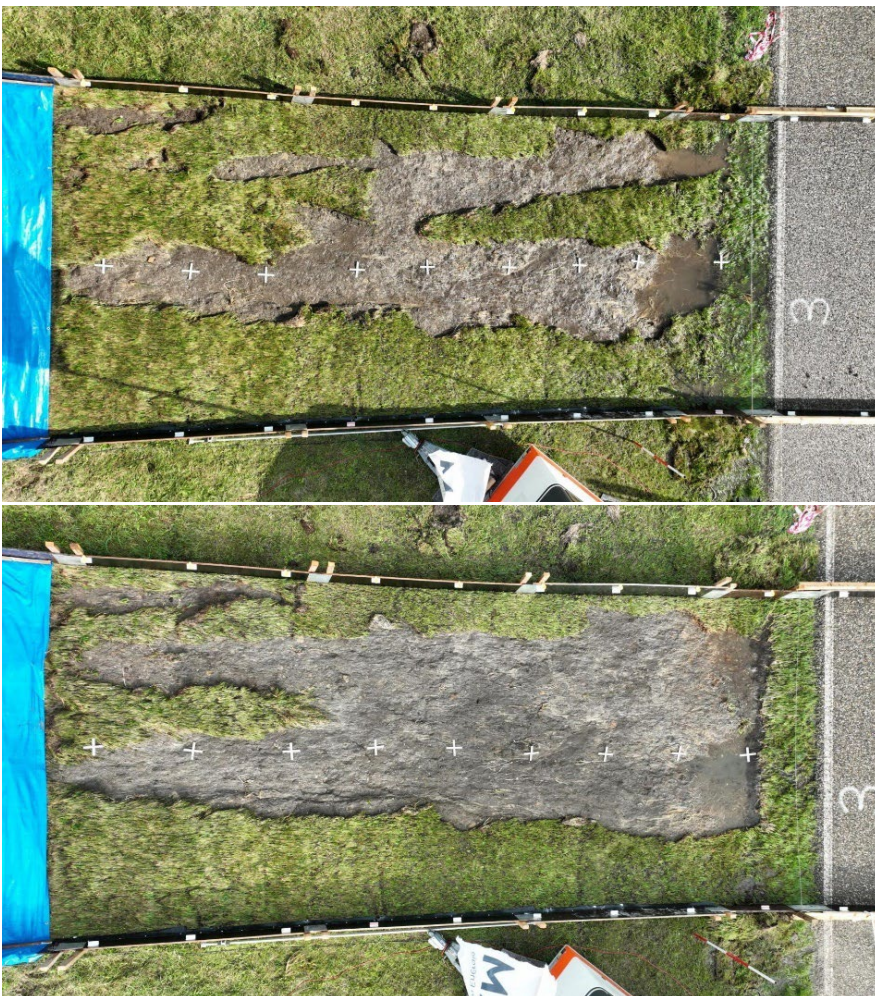
Figuur 50: Schadebeeld boventalud halverwege (boven) en aan het einde van proef GO100_1 (onder), teststrook 3.
