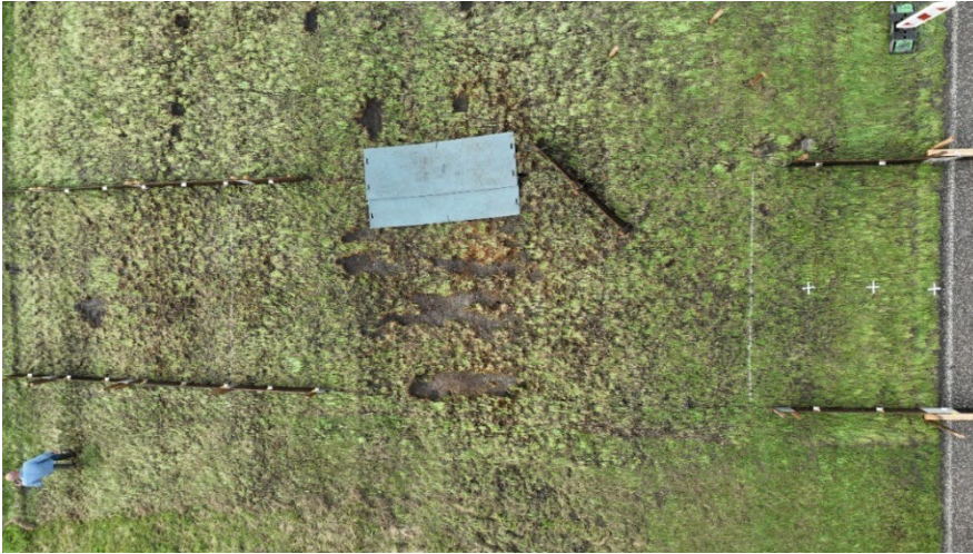
Figuur 30: De afgedekte schade en geleideschotten verwijderd na twee stormuren proef GO100_3.2, teststrook 0.
