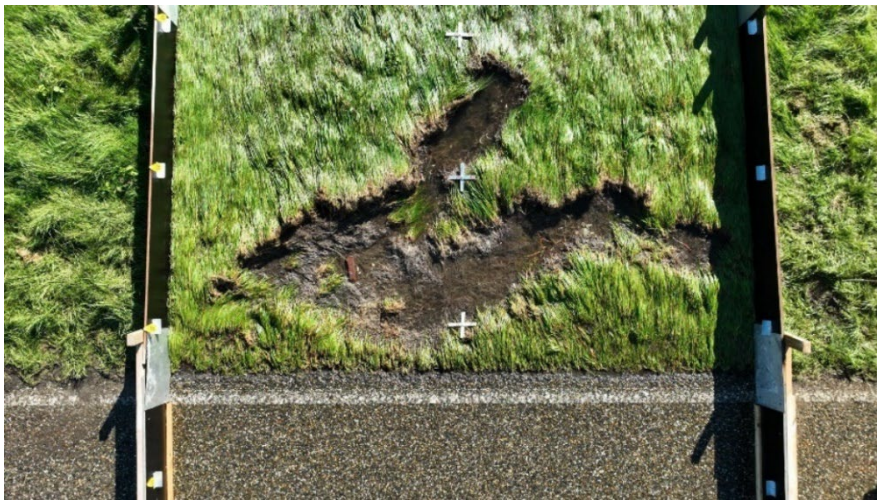
Figuur 60: Aangebrachte schade einde proef GO100_1, teststrook 4.
