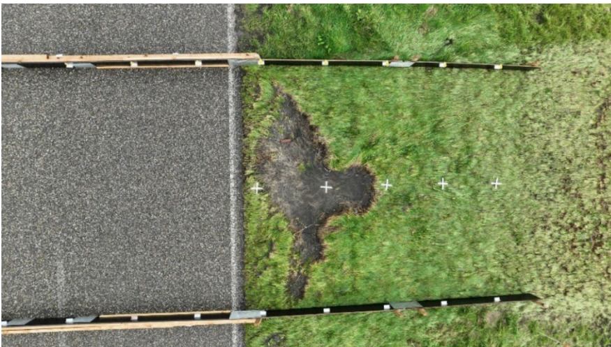
Figuur 62: Aangebrachte schade einde proef GO50_3.2
