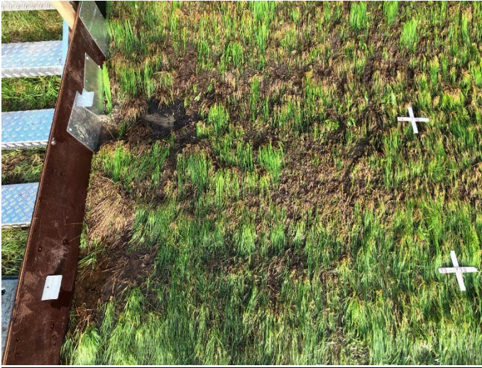
Figuur 15: Erosie in vak 13A einde proef GO10_1, teststrook 0.
