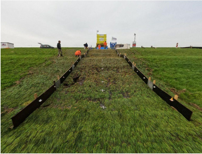
Figuur 42: Schadebeeld ondertalud einde proef GO50_3.2, teststrook 2.
