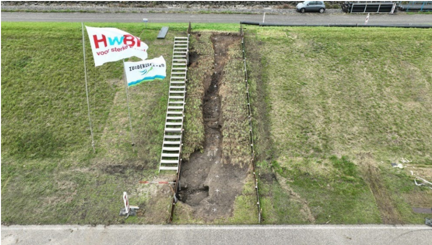
Figuur 28: Schade boventalud einde proef GO100_3.2, teststrook 0.
