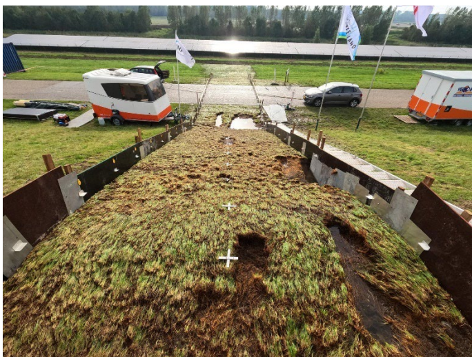
Figuur 19: Erosie in vak 1A (L175xB50xD10 cm) en 1B (L130xB35xD11 cm) na vier stormuren proef GO50_3.2, teststrook 0.
