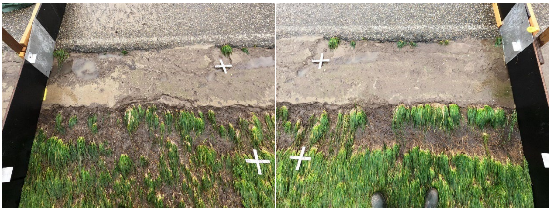
Figuur 67: Lichte slijtage NovoCrete® ter plaatse van overgang asfalt-gras einde proef GO100_3.2, teststrook 1 (sessie 1).
