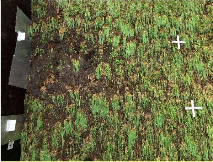
Figuur 13: Kale plek in vak 4A einde proef GO1_1, teststrook 0.
