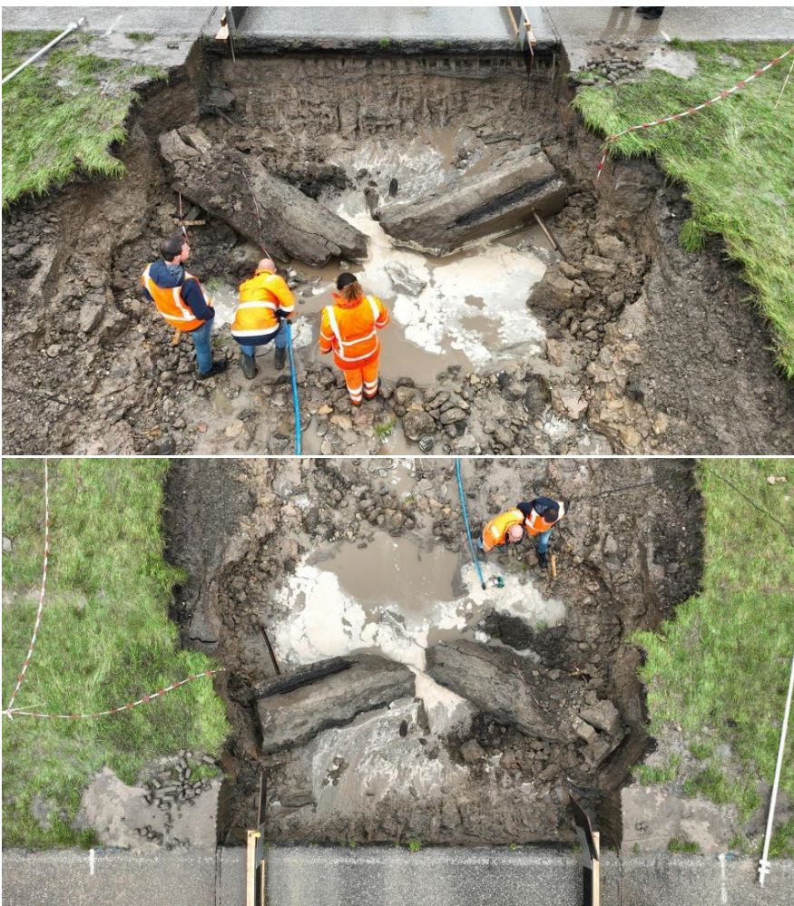
Figuur 76: NovoCrete® bezwijkt onder eigen gewicht en breekt in tweeën na 75 minuten proef GO100_1, teststrook 1 (sessie 3).
