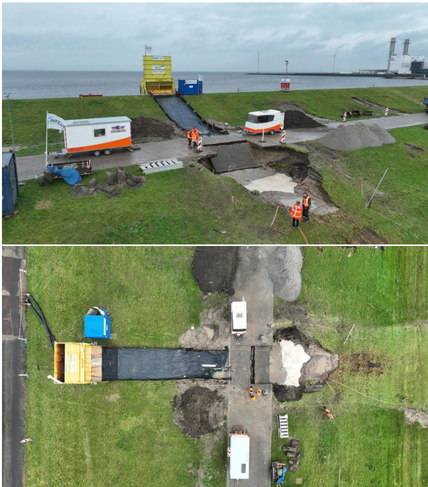
Figuur 80: Impressie schades teststrook 1 (sessie 3 en 4).
