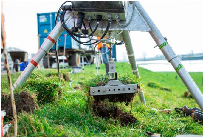
Figuur 81: Met de graszodetrekker wordt de zode uit het talud getrokken.
