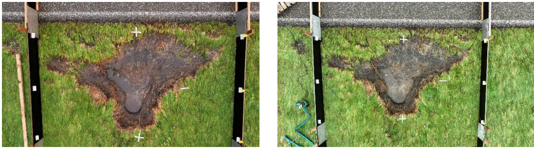
Figuur 63: Aangebrachte schade na 4 uur (links) einde (rechts) proef GO100_3.2, teststrook 4.
