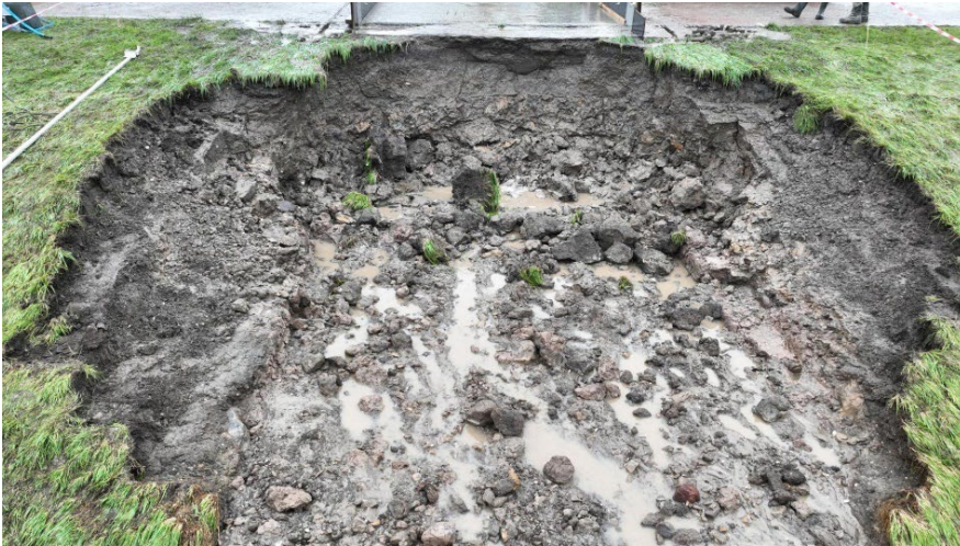
Figuur 75: Kliferosie tot aan de NovoCrete® na 45 minuten proef GO100_1, teststrook 1 (sessie 3).
