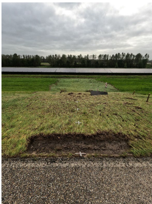
Figuur 32: Aangebrachte schade overgang asphalt-gras einde proef GO100_3.2, teststrook 0.
